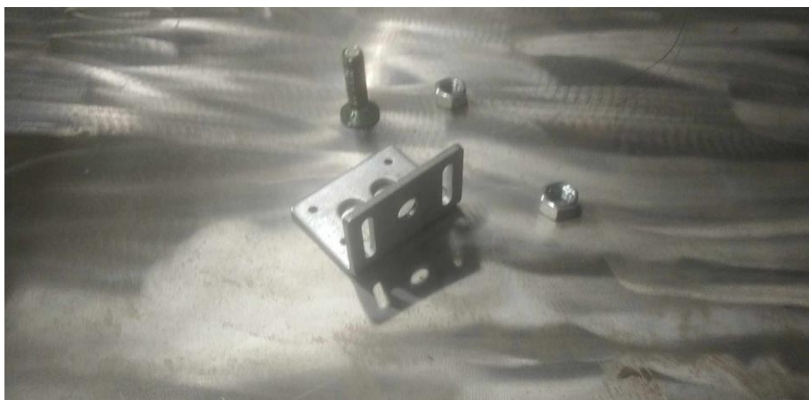
รูปที่ ก.36 รางแบบ และเจาะรูขนาด 8 มิลลิเมตร ตัวยึดมอเตอร์
