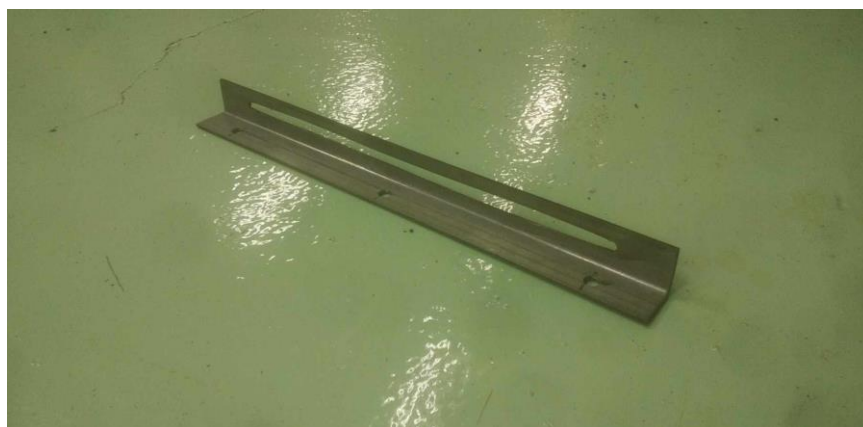
รูปที่ ก.29 ตัด Stainless ร้างแบบ ตัดช่อง Slide ร้างแบบ เจาะรูขนาด 7 มิลลิเมตร
