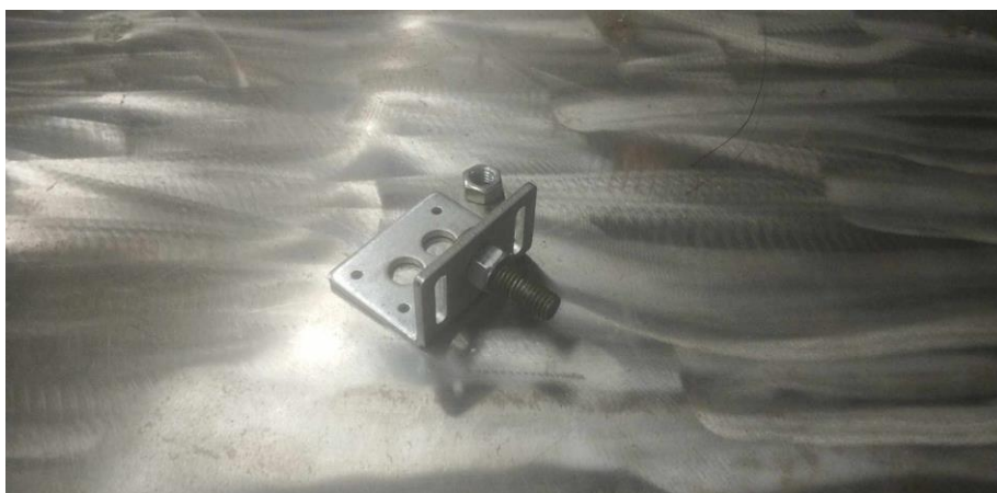
รูปที่ ก.37 นำน็อตตัวผู้ใส่เข้าไปในรูที่เจาะ และขันน็อตตัวเมียเข้าไป
