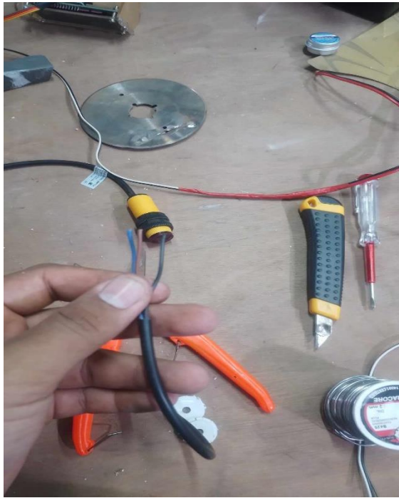
รูปที่ ก.7 ตัดสายที่เชื่อมต่อกับขา Sensor
