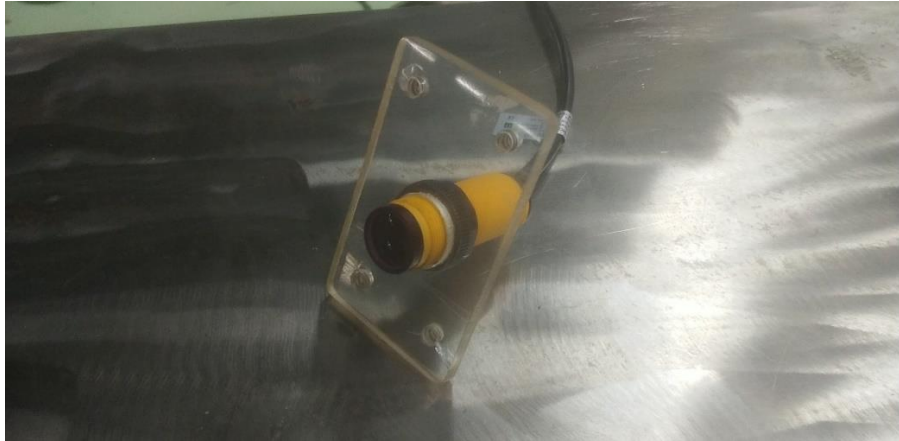
รูปที่ ก.33 นำ Acrylic รางแบบเจาะรู ช่อง Sensor ใช้ Hold Saw ขนาด 18 มิลลิเมตร
