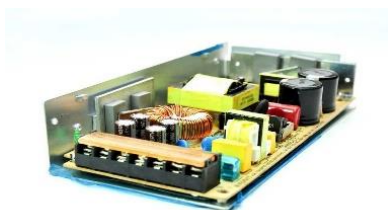
รูปที่ 2.9 ภาพวงจร Switching [8]
