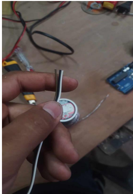
รูปที่ ก.8 ตัดสายไฟที่ต้องบัดกรีเข้ากับขา Sensor
