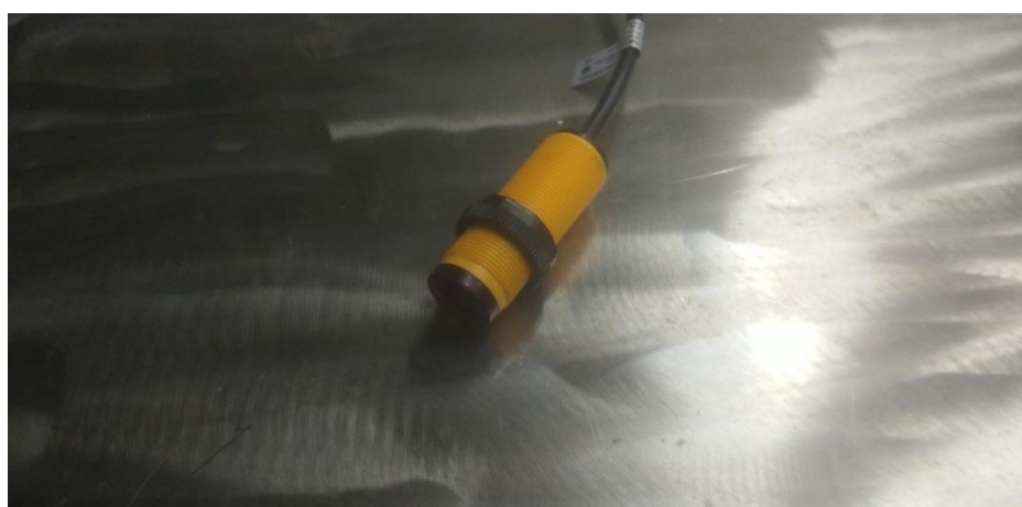
รูปที่ ก.32 นำ Sensor ที่บัดกรีสายสำเร็จแล้วมาเตรียม
