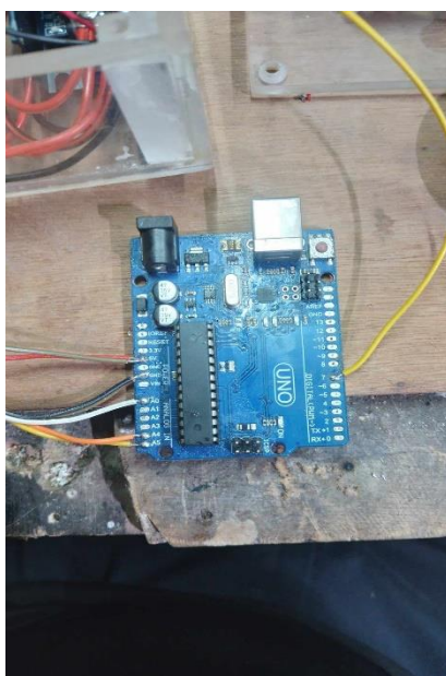
รูปที่ ก.28 ถอดช่องเสียบขา แล้วบัดกรีสายเข้ากับตัว Arduino
