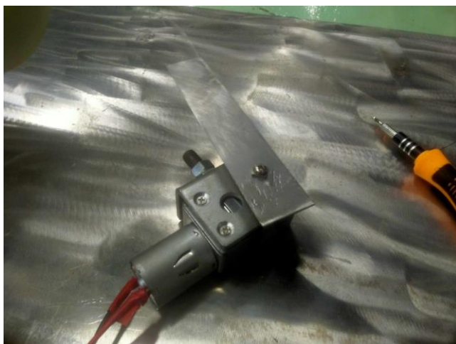
รูปที่ ก.42 ยึดใบมีดเข้ากับมอเตอร์
