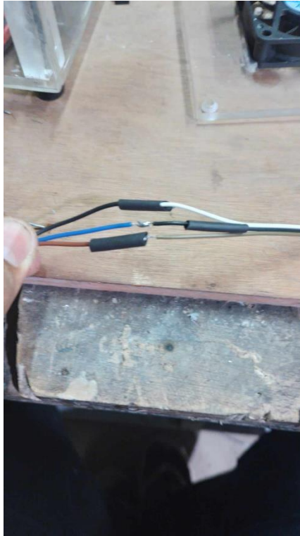
รูปที่ ก.11 เมื่อทำการบัดกรีสำเร็จแล้วเลื่อนท่อหุ้มสายดำแหน่งที่บัดกรี
