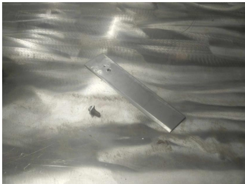
รูปที่ ก.41 นำใบมีดมาเตรียม และน็อตยึดกับปลายมอเตอร์
