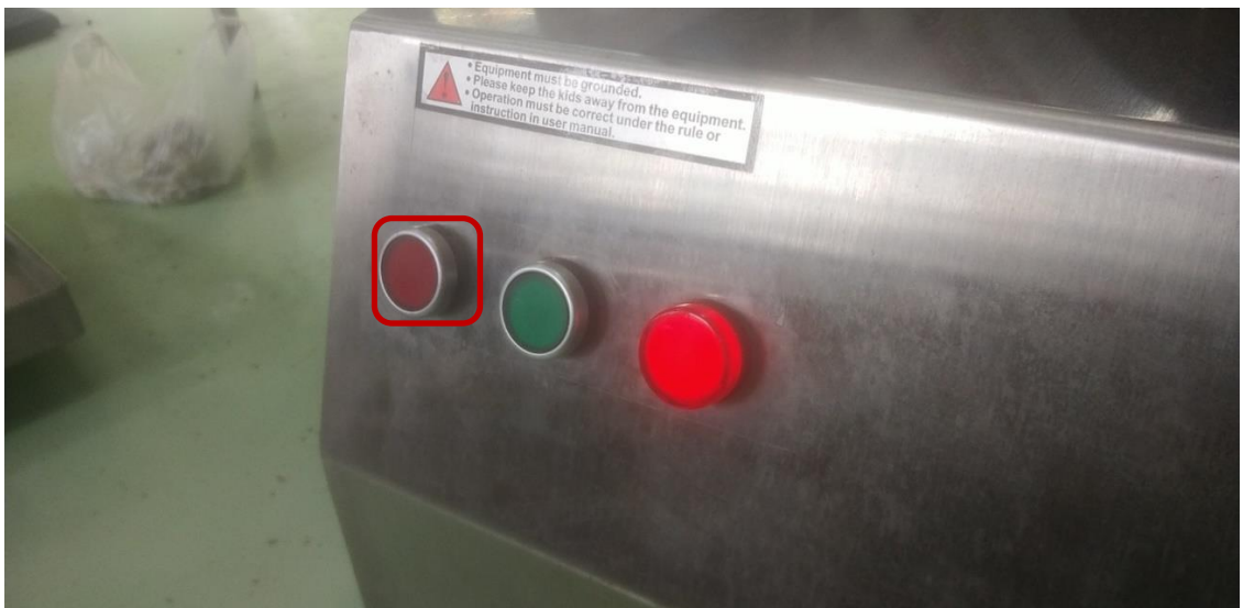
รูปที่ ข.4 เมื่อกดปุ่มสีแดงระบบตัวเครื่องจะหยุดทำงาน
