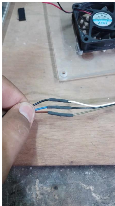
รูปที่ ก.12 นำเครื่องเป่าลมร้อนเป่าจนกว่าท่อหดตัว
